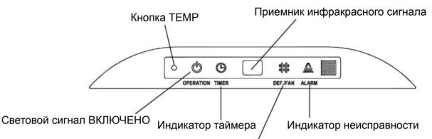
Индикатор PRE-DEF (кондиционер с режимами отопления и охлаждения) или индикатор вентилятора (кондиционер с режимом только охлаждения)
